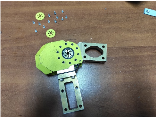
Рисунок 5.5. Место крепления шайб-фланцев и пластиковых накладок
