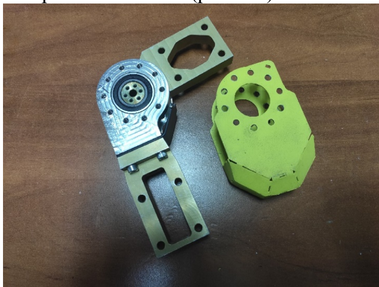
Рисунок 5.4. Колено и коленный шарнир
