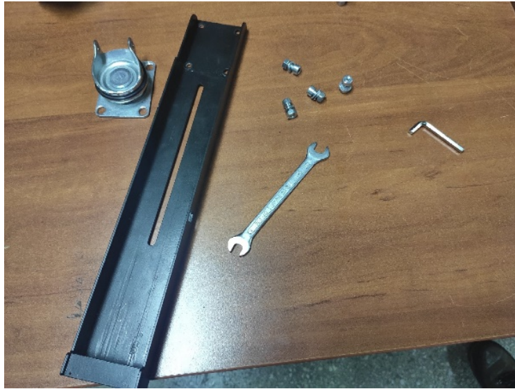
Рисунок 5.10. Корпус голени и голеностопный шарнир
