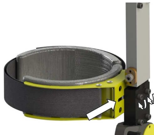
Рисунок 3.2 – Схема регулировки вылета бедренной манжеты
