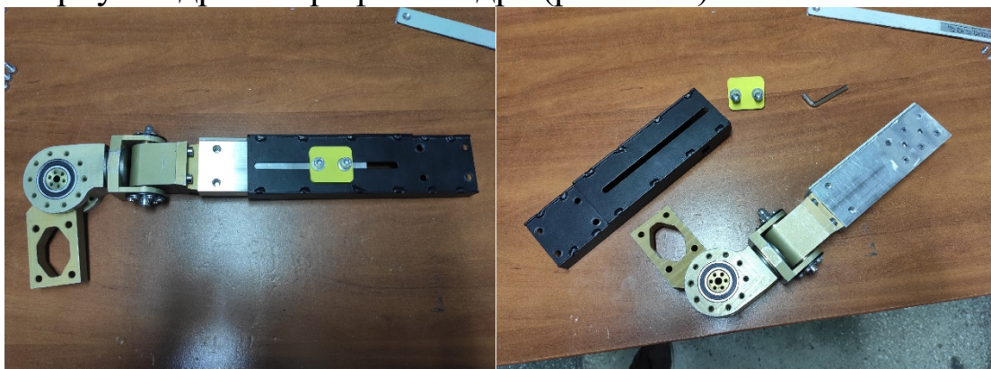
Рисунок 4.11. Отделение регулировочного крепления и корпуса бедра от профиля бедра
