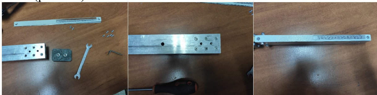
Рисунок 5.9. Присоединение регулировочной пластины и линейки к профилю голени
