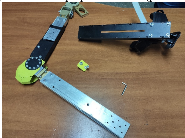
Рисунок 4.2. Рассоединенные регулировочное крепление, корпус голени и профиль голени
