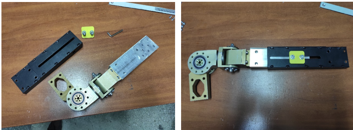
Рисунок 5.3. Соединение профиля бедра и корпуса бедра регулировочным креплением
