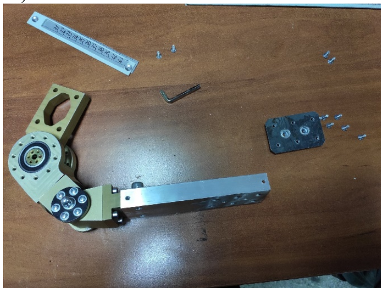
Рисунок 5.2. Место крепления регулировочной пластины и линейки
