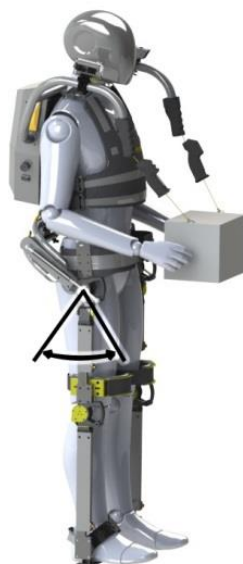
Рисунок 2.2 – Диапазон вращения бедренного шарнира при ходьбе
