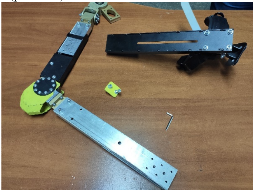
Рисунок 5.12. Профиль голени, корпус голени со стопой и регулировочное крепление
