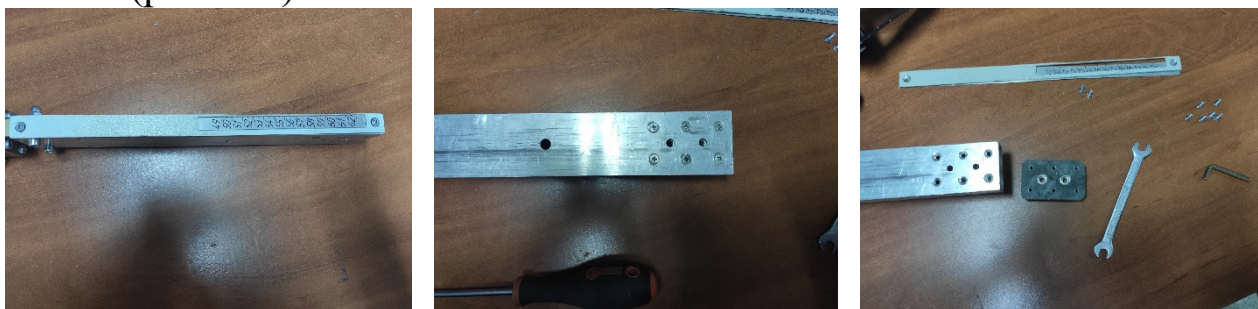
Рисунок 4.5. Отделение линейки и регулировочной пластины от профиля голени
