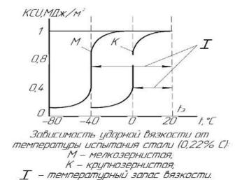
Ударная вязкость двух сталей при температуре эксплуатации, равной 20°С, одинакова. Однако переход в хрупкое состояние стали М (мелкозернистая) заканчивается при -40°С, а стали К (крупнозернистая) при 0°С. По сравнению с температурой эксплуатации t<sub>3</sub> запас вязкости у стали М составит Х°С, а у стали К составит У°С. Найдите Х и У. Какая сталь ( М или К ) более надёжна в работе и почему?
