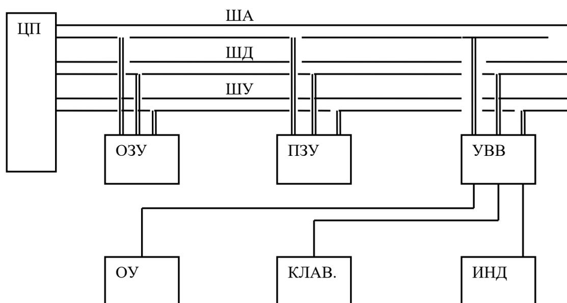
Рис. 1. Обобщенная структурная схема УМПС
