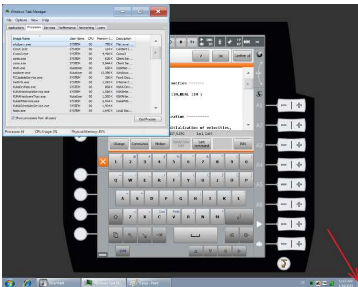
Рис. 7.3 Кнопка сворачивания всех окон и работа диспетчера задач на экране монитора, подключенного к KR С4
