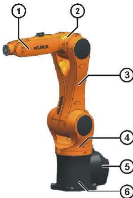
Рис. 2.1 Устройство манипулятора KR AGILUS
