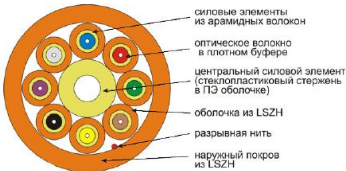
Рисунок 4 - Пример конструкции развивного оптического кабеля
