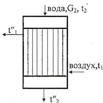
Рис. 4. Расчетная схема теплообменного аппарата
