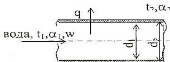
Рис. 3. Расчетная схема теплопередачи через цилиндрическую стенку
