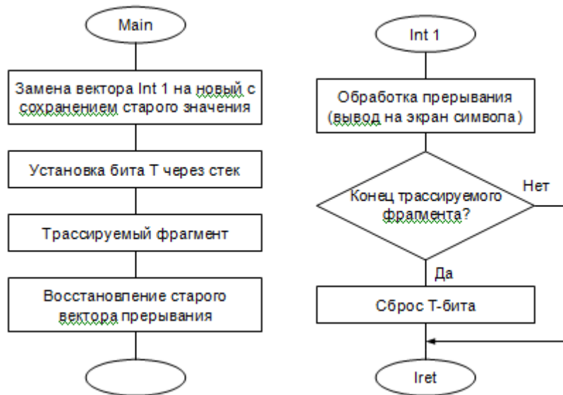
Рис. 3.6. Алгоритм трассировки со сбросом Т-бита в обработке
