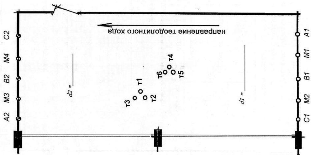
измерения горизонтального угла способом приёмов
