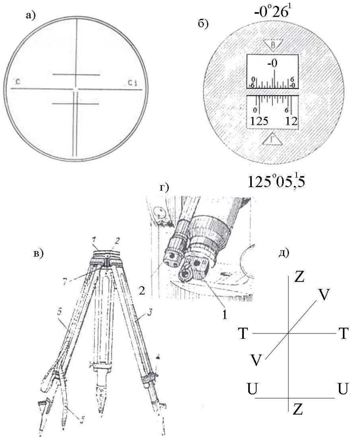
Рис.2. Элементы измерительной системы а- изображение сетки нитей, б- поле зрения микроскопа, в- штатив г- окулярные насадки , д – осевая схема прибора
