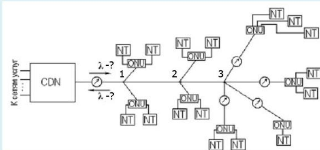
конфигурация - пассивная оптическая сеть, которую можно представить в виде ветвящегося «дерева», где к одному оптическому волокну подключаются CDN и N-ое количество ONU;
