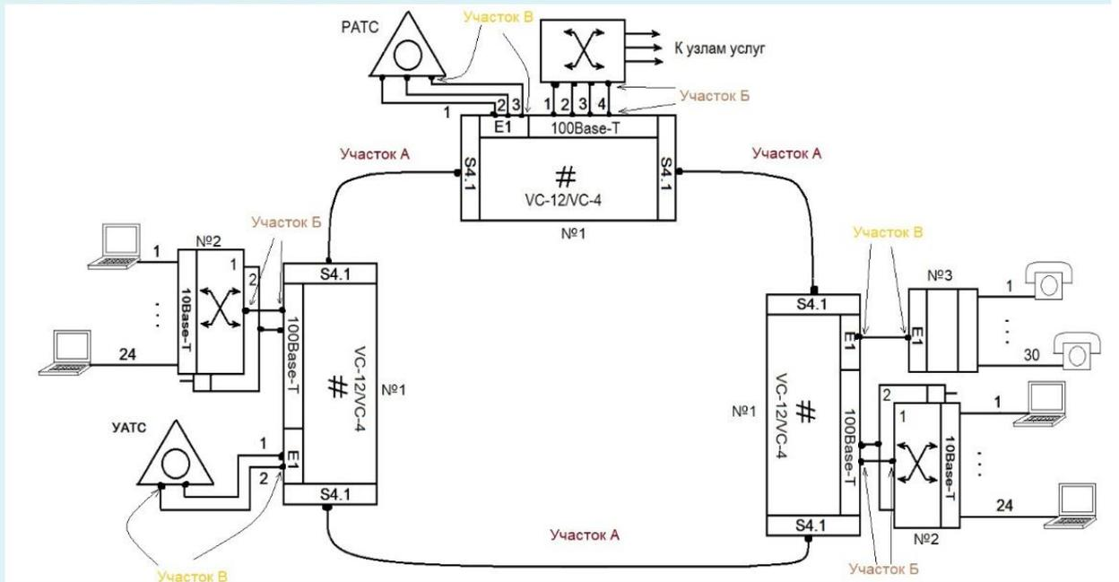
Физическое соединение с помощью оптического волокна должно осуществляться на типовых участках, обозначенных как...
