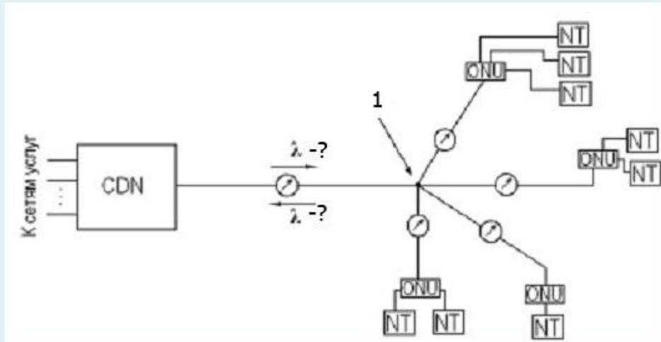
конфигурациях - пассивная оптическая сеть, которую можно представить в виде ветвящегося «дерева», где к одному оптическому волокну подключаются CDN и N-ое количество ONU;
