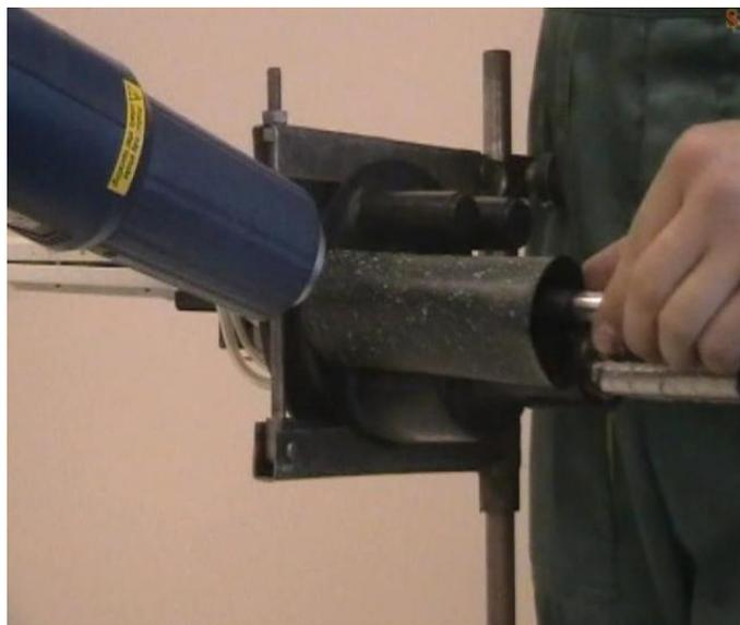
Рисунок 17 - Усаживание термотрубки
