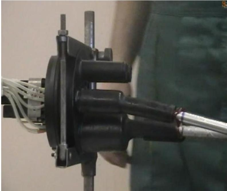
Рисунок 18 - Красный клей на кабеле и крае трубки
