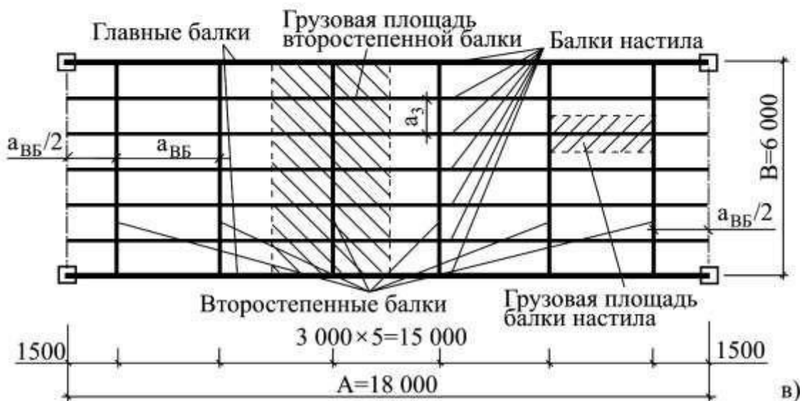
Рисунок 1.1 – Схемы балочных клеток а, б – нормального типа, в – усложненного типа
