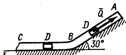
Груз  $D$  массой  $m$ , получив в точке  $A$  начальную скорость  $V_0$ , движется в изогнутой трубе  $ABC$ , расположенной в вертикальной плоскости; участки трубы или оба наклонные, или один горизонтальный, а другой наклонный (табл.).
