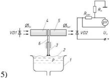
е) цифрой мембраннооптоволоконный прибор для измерения давления
