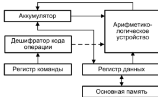
Рисунок 4.2 – Архитектура аккумуляторной машины
