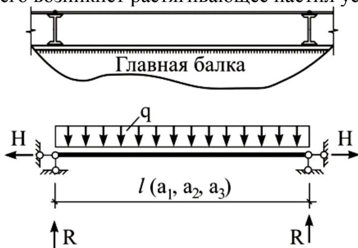
Рисунок 1.2 – конструкция и расчетная схема настила
