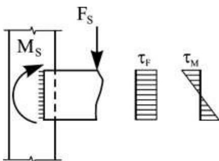
Рисунок 4.3 – К расчету сварных швов планки
