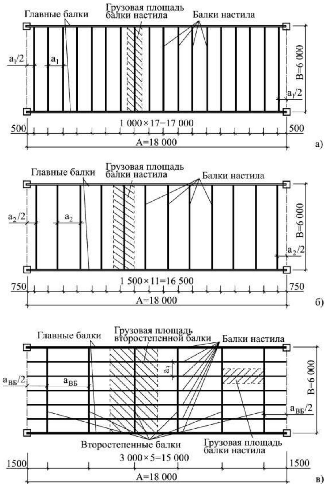
**Рисунок 1.1** – Схемы балочных клеток
