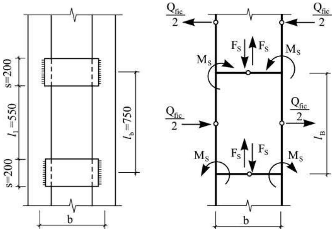
Рисунок 4.2 – К расчету планок сквозной колонны
