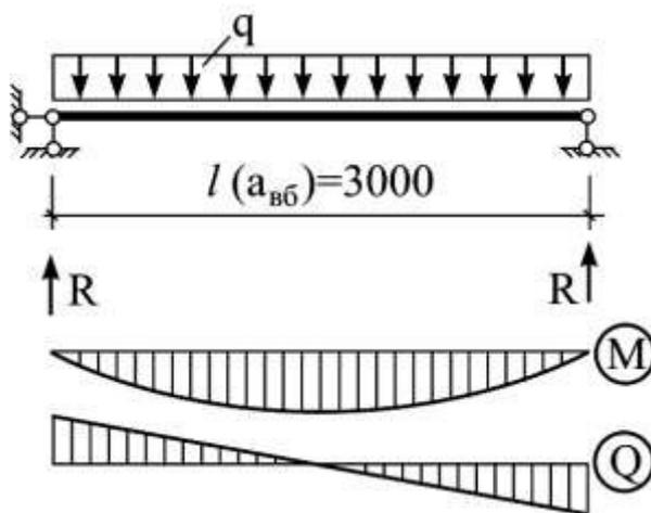
Рисунок 1.5 – Расчетная схема балки настила по 3 варианту
