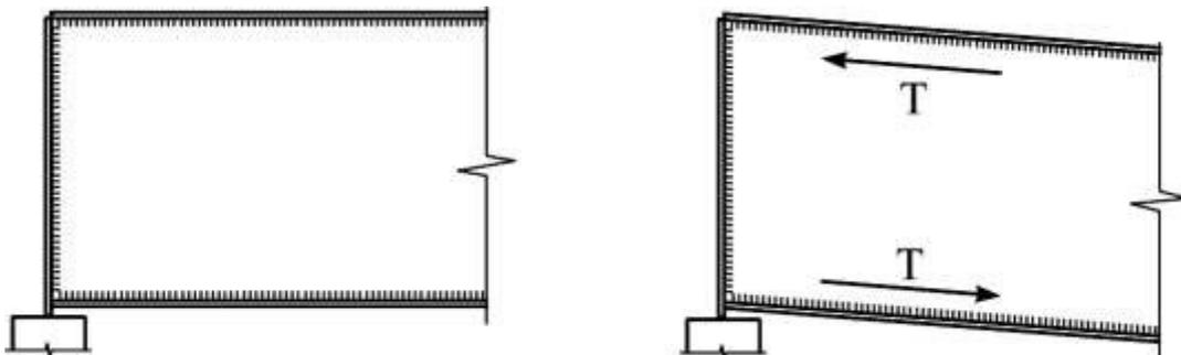
Рисунок 2.9 – К расчету поясных сварных швов
