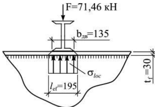
Рисунок 2.7 – Местные напряжения в стенке главной балки
