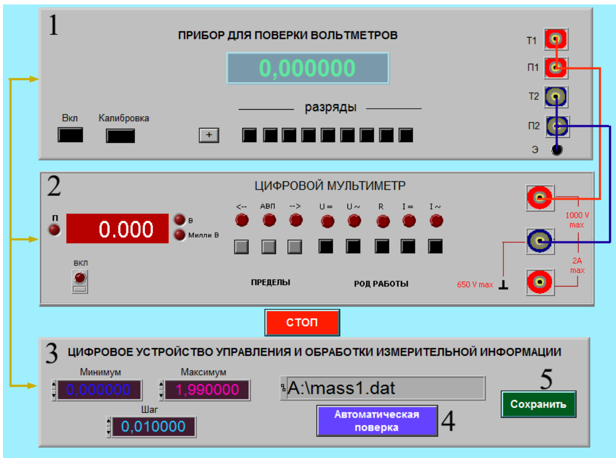
Рисунок 1 - Вид модели лабораторного стенда на рабочем столе компьютера: 1-прибор для поверки вольтметров; 2-электронный цифровой мультиметр; 3-устройство управления; 4-кнопка запуска режима автоматической поверки; 5- кнопка запуска режима сохранения экспериментальных данных
