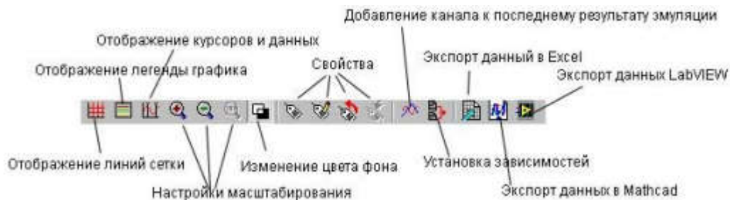
Рисунок 13 – Панель настройки плоттера
