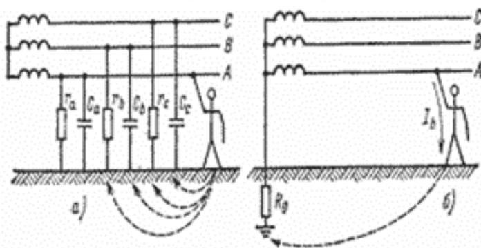
А Однофазное включение человека в цепь тока: а – в сети с изолированной нейтралью; б – в сети с заземленной нейтралью;
