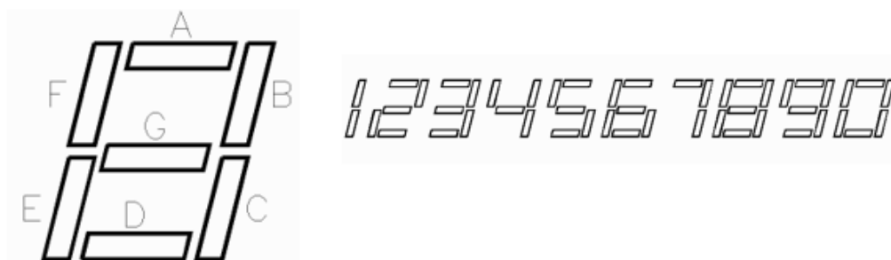
Рисунок 3 - Стандартное расположение сегментов в индикаторах и генерирование цифр с их помощью
