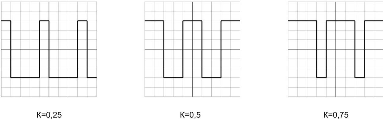
Рисунок 4 – Форма сигналов для различных значений коэффициента заполнения
