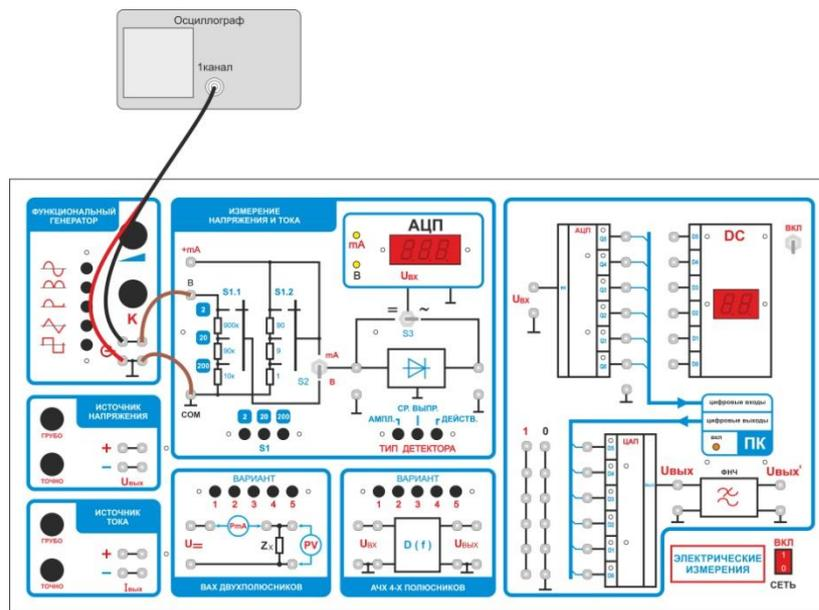
Рисунок 3 – Монтажная схема подключения измерительного прибора
