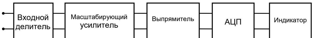
Рисунок 1 – Структурная схема цифрового вольтметра.
