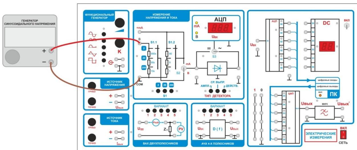
Рисунок 6 – Монтажная схема подключения генератора напряжения
