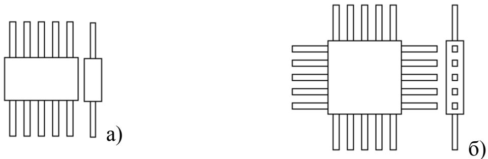
Рисунок 6 - Конструкции корпусов типа 4
