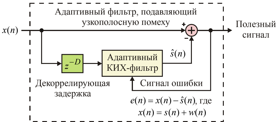
Рис. 4. Адаптивный фильтр для оценивания и подавления узкополосной помехи
