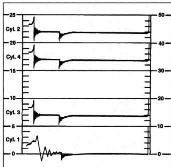
Техник А сказал, что неисправность вызвана прогаром клапана в первом цилиндре.
