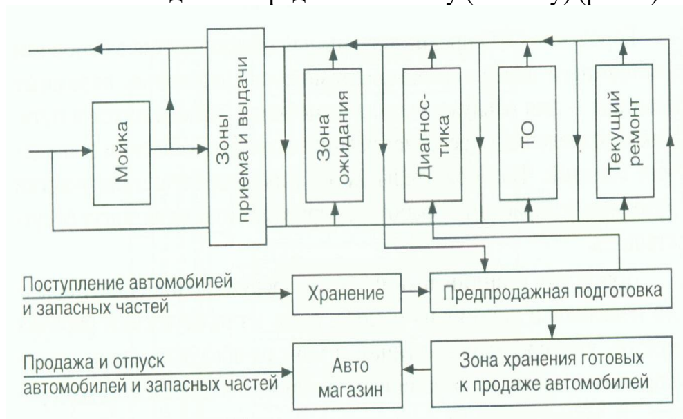
Рис. 4 Схема технологического процесса на СТОА
