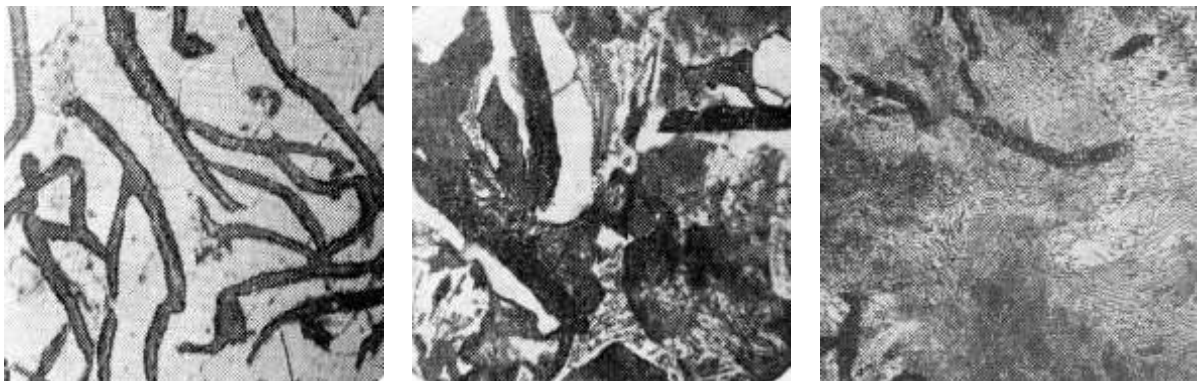
Рис. 10.2. Микроструктура серых чугунов ( \times 150 ) а – ферритный; б – феррито-перлитный; в – перлитный
