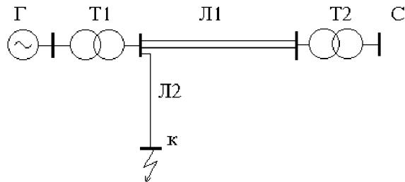
Г:  $P = 6 \times 63 \text{ Мвт}$       Т1:  $S = 4 \times 125 \text{ МВА}$       Т2:  $S = 2 \times 250 \text{ МВА}$       С:  $U_c = 230 \text{ кВ}$
