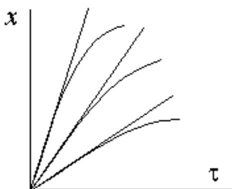
Рис. 3.6 20 -Графическое дифференцирование начальных участков кинетических кривых  $x = \varphi(\tau)$ , полученных при разных начальных концентрациях реагента  $A_1$  и одной и той же начальной концентрации  $A_2$
