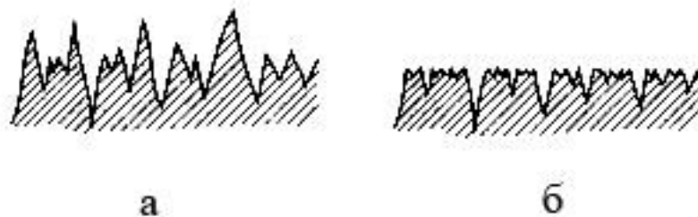
Рис. 1. – Профили поверхности цилиндра: а – при хонинговании одним бруском; б – при плосковершинном хонинговании или после приработки.
