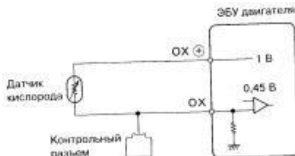
Рис. 2.1(б). Схема включения титанового кислородного датчика
