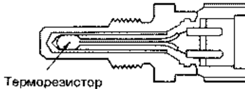
Рис. 1.1. Конструкция датчика температуры
