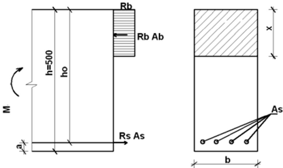
Изгибаемый элемент прямоугольного сечения с размерами  $b = 200$  мм,  $h = 500$  мм.
