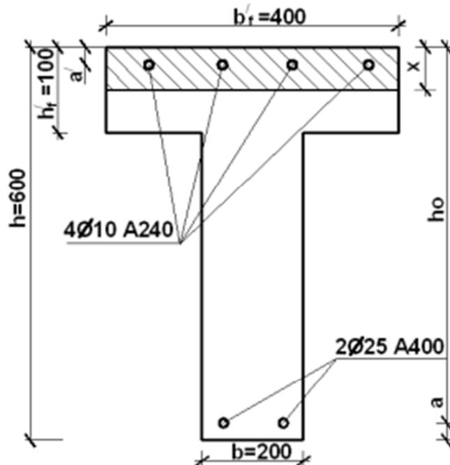
Изгибаемый элемент таврового сечения с размерами:  $b = 200\text{мм}$  ,  $h = 600\text{мм}$  ,  $b' f = 400\text{мм}$  ,  $h' f = 100\text{мм}$ .
