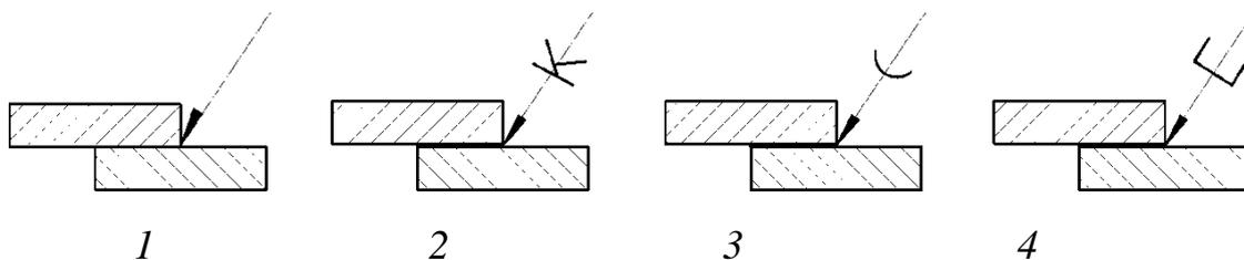
1.7 Правильное обозначение секущей плоскости показано на рис. \_\_\_\_.
