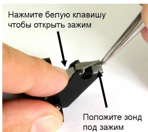
Рис. 10 Установка зонда в держатель
