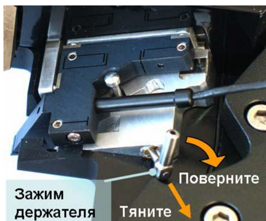
Рис. 8 Держатель зонда, зафиксированный зажимом
