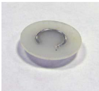
Рис. 5 Держатели образца: 1 – базовый держатель, 2– магнитный держатель.
