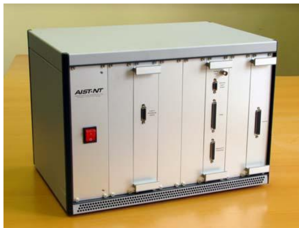
Рис. 1,б Контроллер зондового микроскопа
