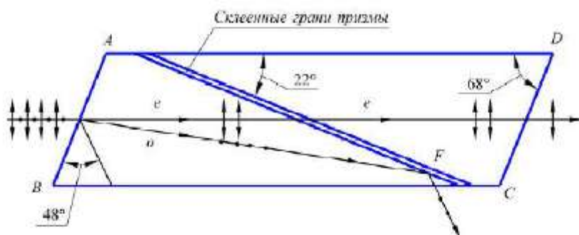
Рис. 15. Ход линейно поляризованных лучей в призме Николя Луч света, входя в кристалл делится на два поляризованных луча е и о. Луч о, обладающий большим коэффициентом преломления,
