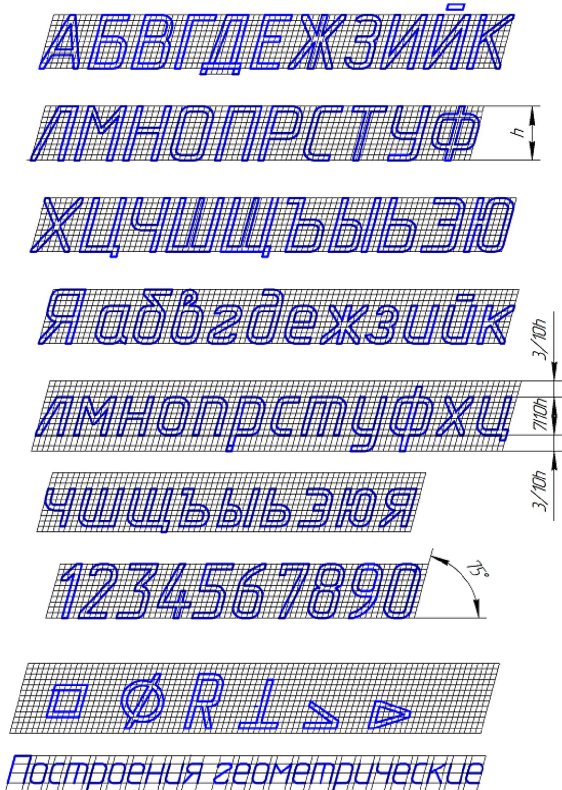
Рисунок 1.4 – Шрифт типа Б с наклоном
