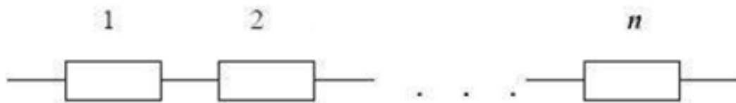
Рисунок 1 – структурная схема надёжности с последовательным соединением элементов.
