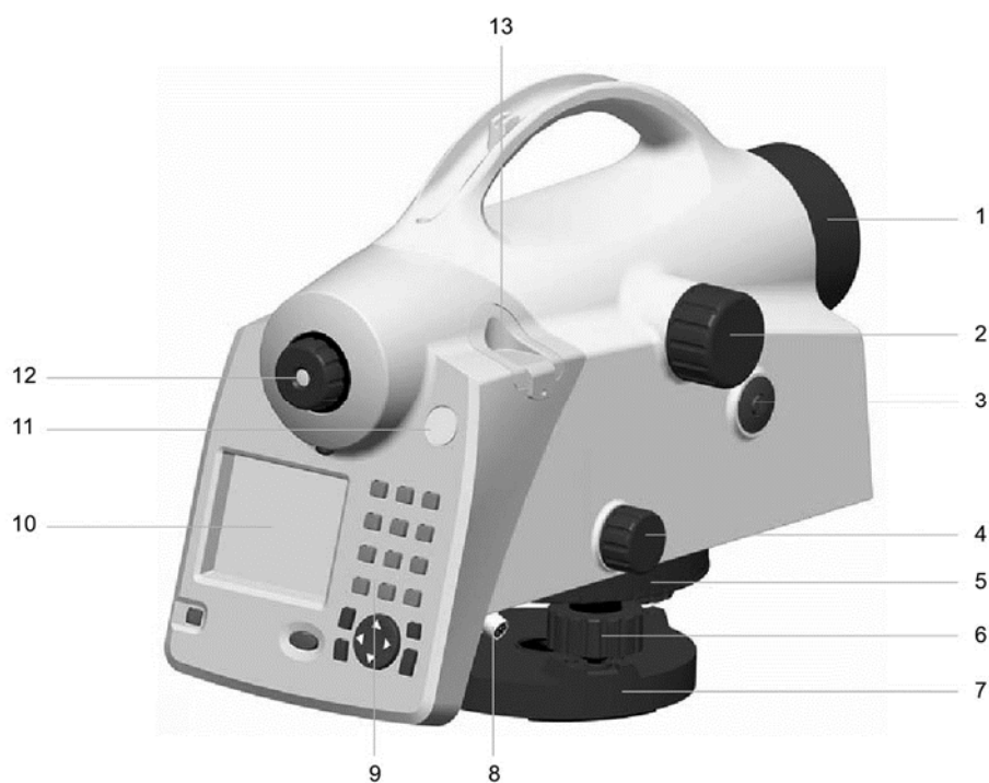
Рис. 2.7. Внешний вид нивелира Trimble DiNi:
