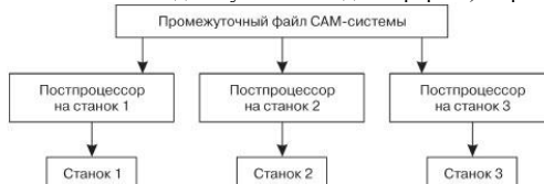
Рис. 12.28. Схема получения УП для конкретного комплекса «Станок – система ЧПУ»
