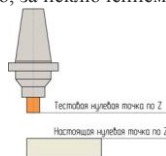
Рис. 3.11. Очень часто перед настоящей обработкой детали «поднимают» нулевую точку по оси Z и УП «прогоняют по воздуху»
