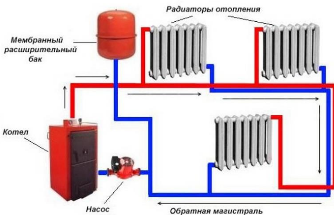
Рис.2 – Система отопления с искусственной циркуляцией
