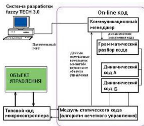
Рисунок 4 – система управления при On-line-оптимизации
