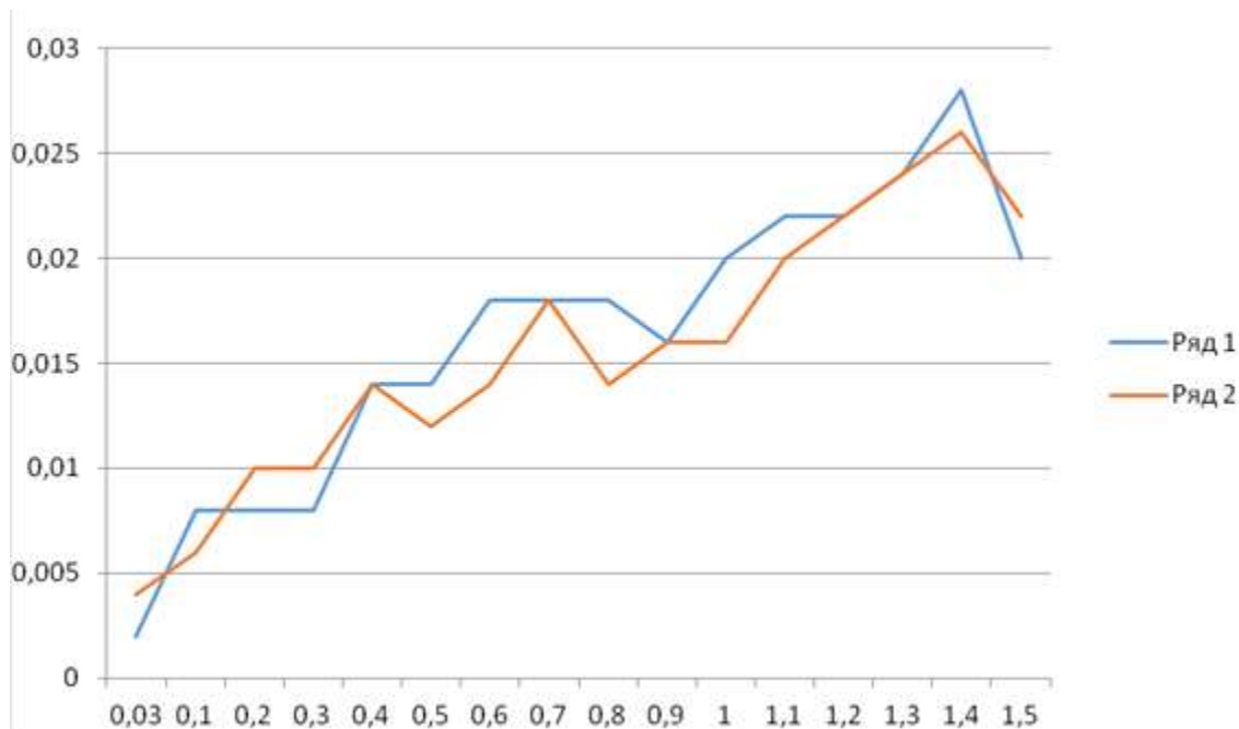
Рисунок 2 – Абсолютная погрешность аналогового прибора при движении стрелки вверх по шкале и вниз, В
