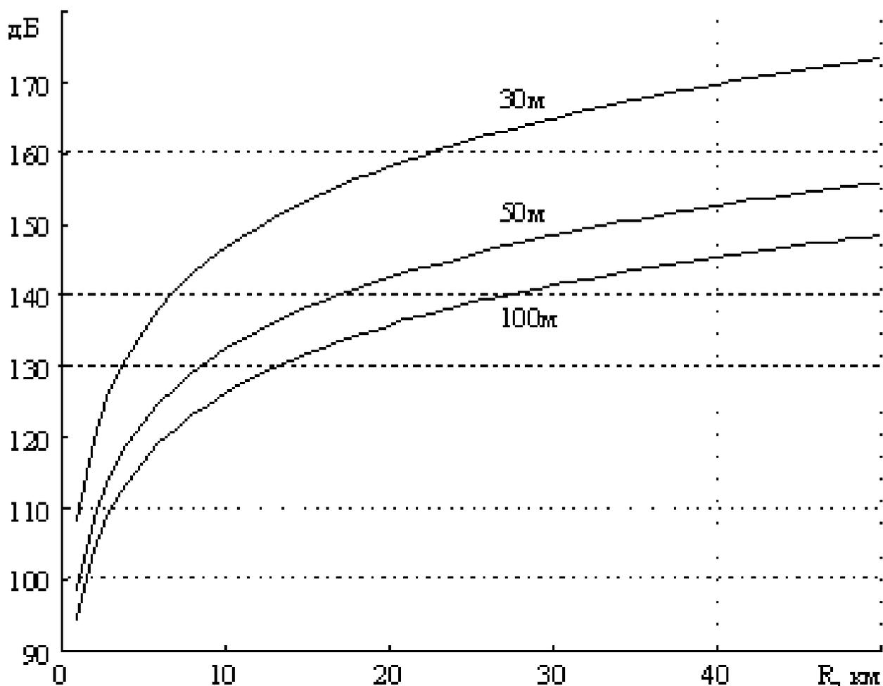
Рис. 1. График зависимости  $L_{OA}=f(R)$  для сельских условий.
