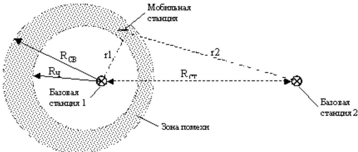
Рис. 3. Радиус связи при помехе от совмещенного канала.
