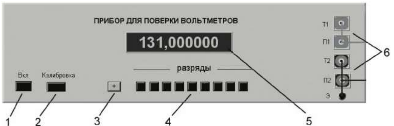
Рисунок 3 – Панель виртуального прибора для поверки вольтметров
