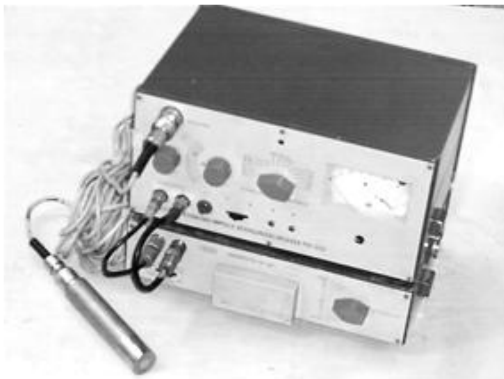
Рис. 10. Внешний вид шумомера PSI 202 с октавным фильтром OF 101 и микрофоном МК-102
