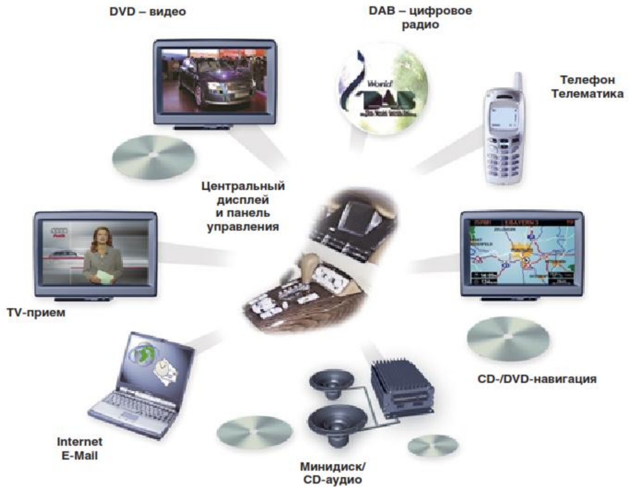
Рисунок 6 – Взаимодействие систем автомобиля по шине MOST.
