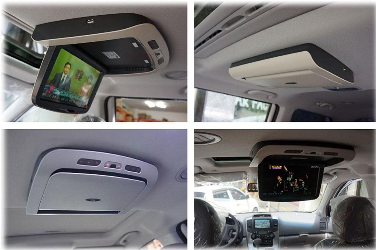
Рисунок 3 – Пример установки подвесных мониторов потолочного типа.
