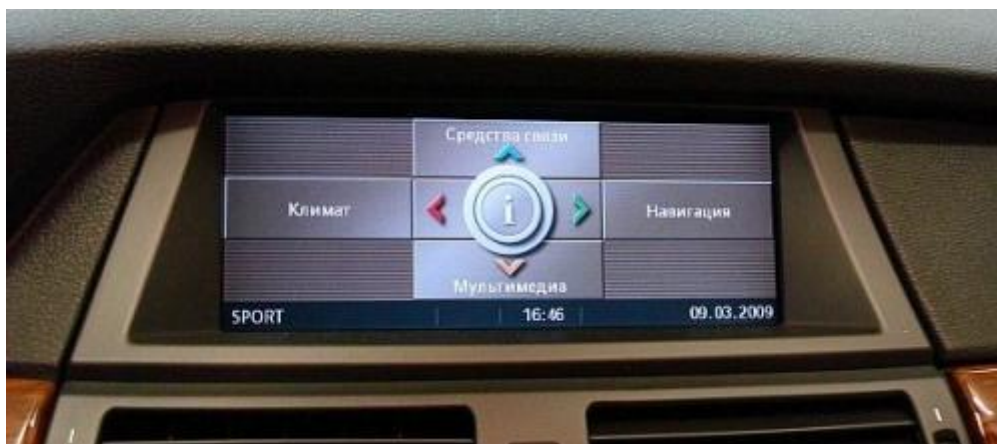
Рисунок 6 - Полная интеграция навигационного модуля в головное устройство на базе Car Communication Computer
