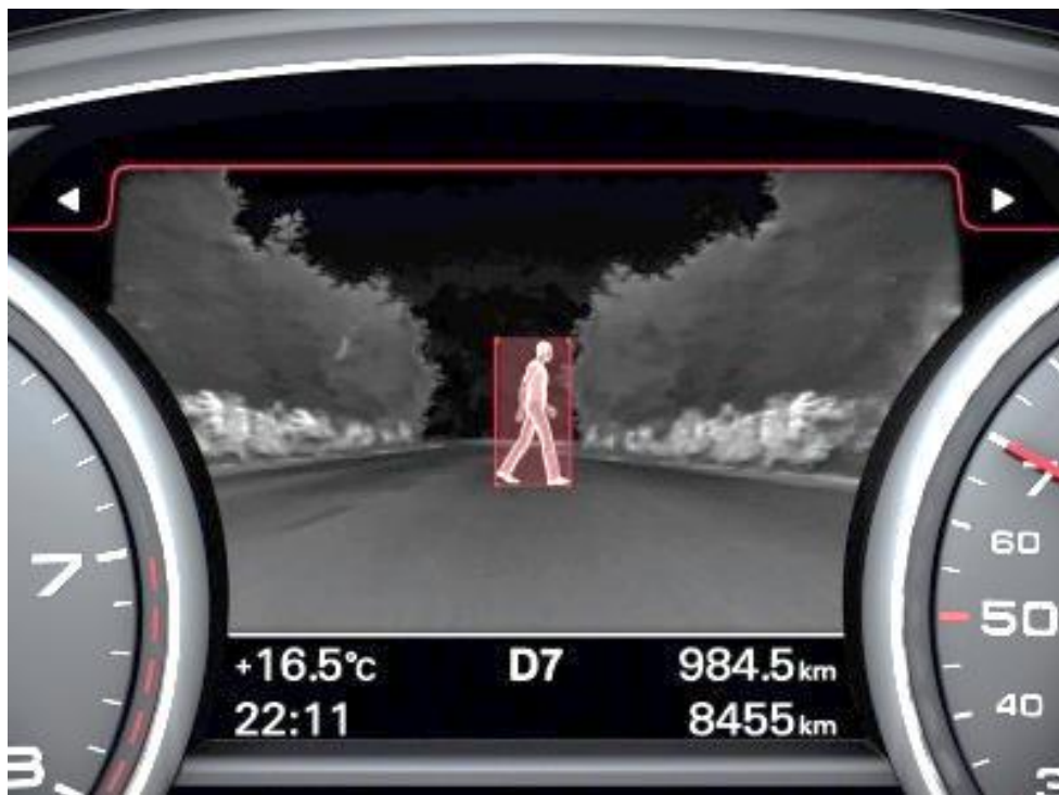
Рисунок 9 – Система ночного видения автомобиля предупреждает о близком нахождении пешехода в зоне движения (подсвечивание красным цветом)
