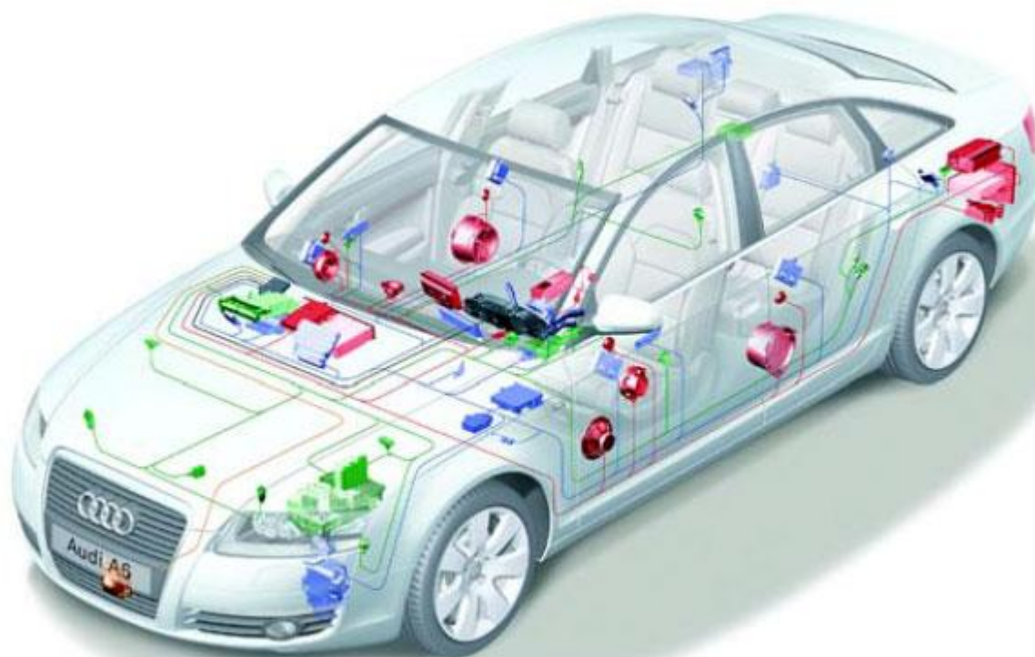
- Сетевая структура бортовых информационных систем автомобиля Audi A6
