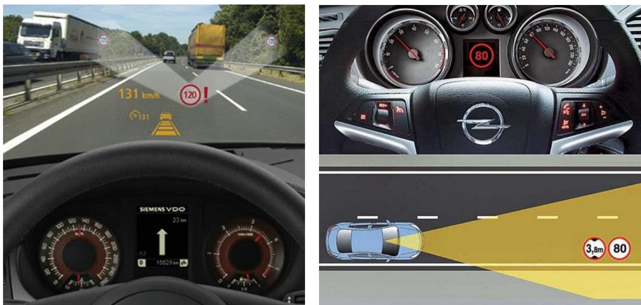
Рисунок 13 – Отображение считанной видеокамерой информации на: а – лобовое стекло; б – на панель приборов.
