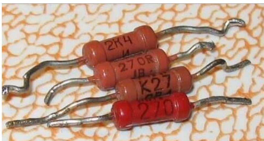
Рисунок 3.1. Резистор МЛТ советского производства с буквенно-цифровой маркировкой.
