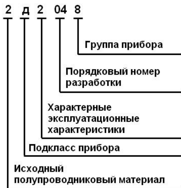
Рисунок 3.12. Расшифровка кода из букв и цифр
