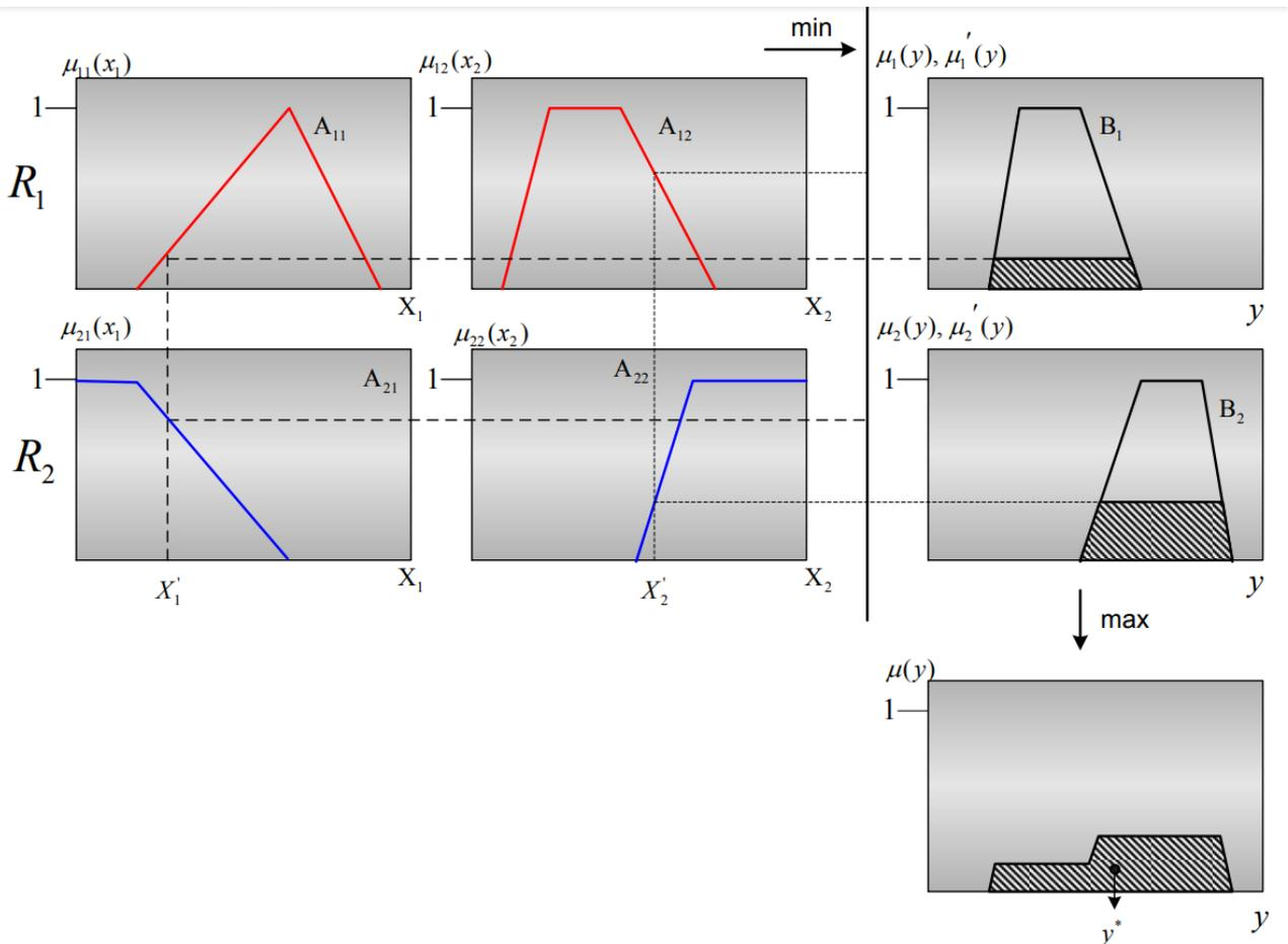
Рисунок 1.1– Графическая интерпретация процесса нечеткого вывода по Мамдани
