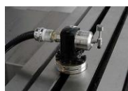
Рис. 15.7. Датчик Renishaw TS-27 для измерения длины и радиуса инструмента
