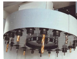
Рисунок 1.7 - Дискový инструментальный магазин с вертикальной осью фрезерный станка мод. ЛФ260МФ3
