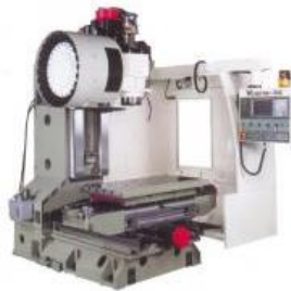
Рисунок 3.5 - Установка магазина на шпиндельной бабке станка
