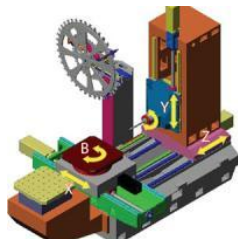
Рисунок 3.3 - Схема устройства смены инструмента путем относительного перемещения шпинделя: станок горизонтальный сверлильно-фрезерно-
