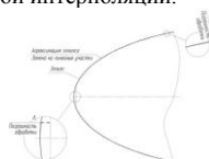
Рис. 12.10. Линейная аппроксимация эллипса в САМ-системе выполняется с заданной точностью
