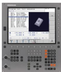
Рис. 1.3. Стойка ЧПУ Heidenhain TNC
