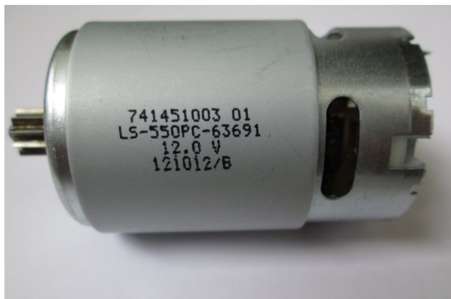
Рисунок 3.1 – Двигатель постоянного тока Leshi motor 550PC
