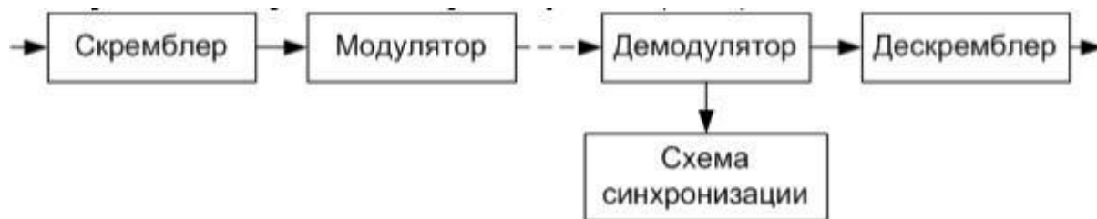
Рис. 1. Схема включения скремблера и дескремблера в канал связи
