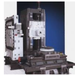
Рисунок 3.4 - Пример цепного магазина (горизонтальный обрабатывающий центр Hyundai Kia KH 50G/63G)
