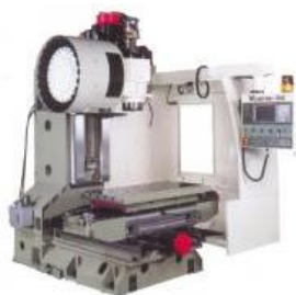
Рисунок 3.5 - Установка магазина на шпиндельной бабке станка
